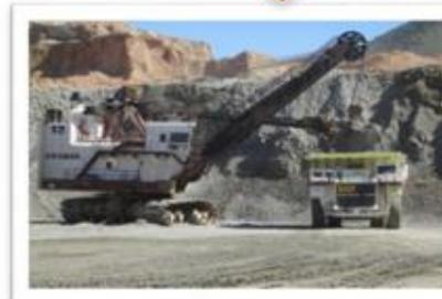
El proceso de cargado se lleva a cabo con palas eléctricas y cargadores frontales
